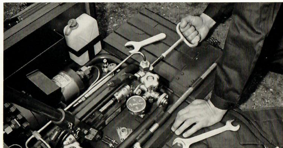
Abb. 13 Auswechseln der Kolbendichtung
