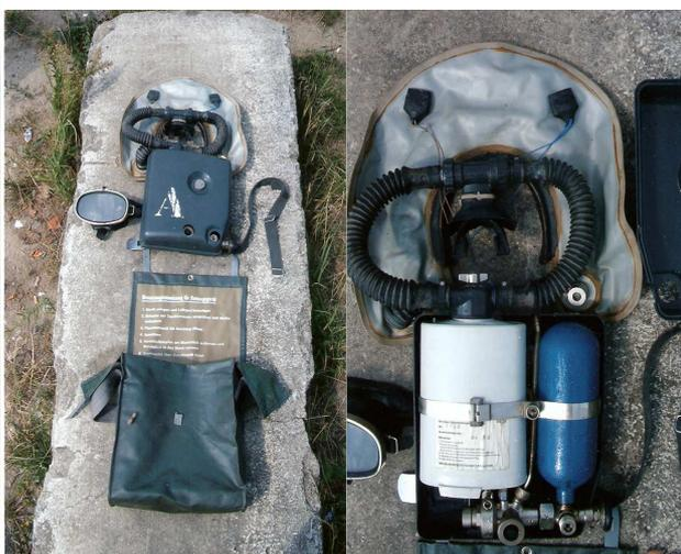
Bild 16 Sauerstoff-Kreislaufgerät
