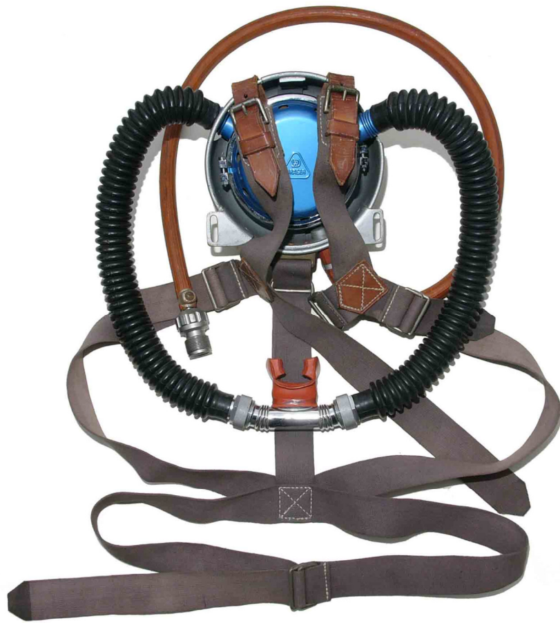
Schlauchtauchgerät mit montiertem Automat, Innenansicht. Das Gerät wurde dankenswerter Weise vom Drägerarchiv für dieses Foto zur Verfügung gestellt.
