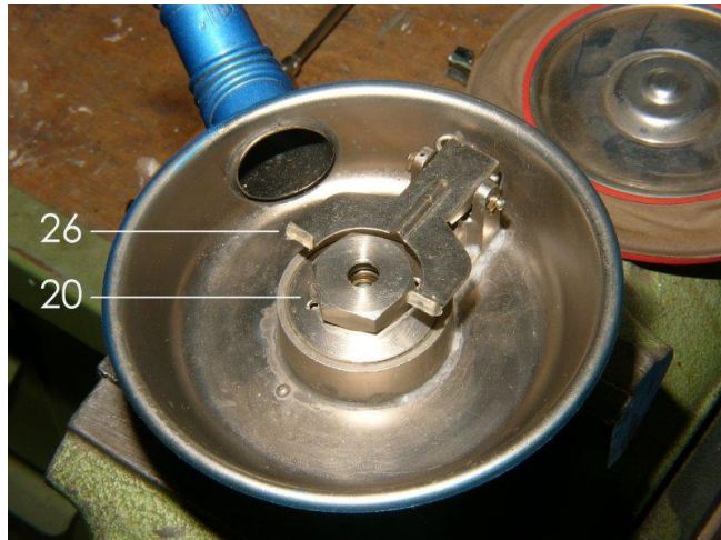
Geöffnetes Automatengehäuse mit dem Y-förmigen Hebel (26) und dem Federgehäuse (20)
